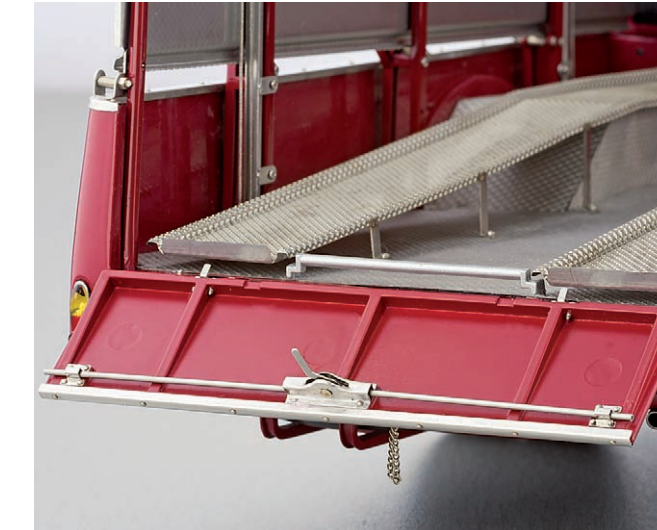
Fahrzeug-Heckklappe mit funktionierender Verriegelungsmechanik
